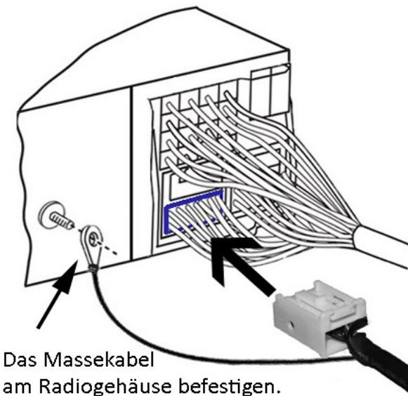
Ist der Steckplatz bereits belegt durch einen blauen Stecker (original AUX-IN / CD-Wechsler oder Media-IN), diesen bitte abstecken. **AUX und Media-IN können weiter verwendet werden**, dafür bitte die Kabel aus dem Originalstecker aus- und am Adapterstecker einpinen. Alternativ kann ein Y-Adapter verwendet werden.
