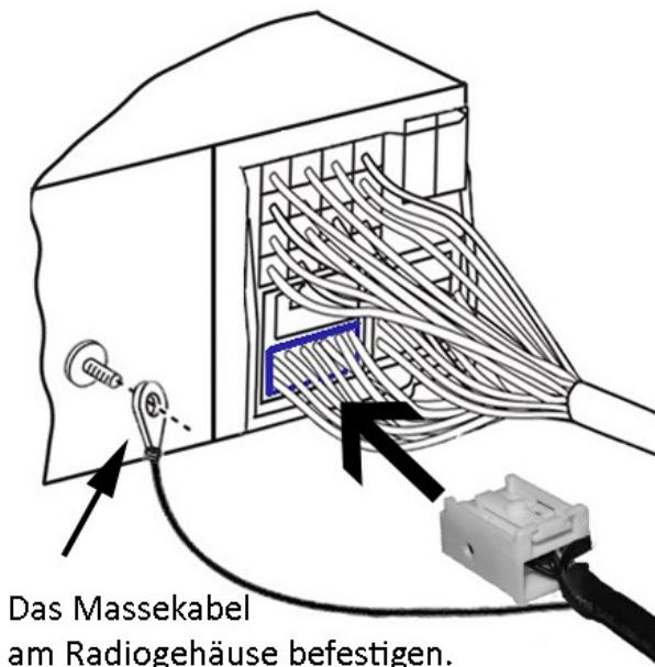
Ist der **Steckplatz bereits belegt** durch einen blauen Stecker (original AUX-IN / CD-Wechsler oder Media-IN), diesen bitte abstecken. **AUX und Media-IN können weiter verwendet werden**, dafür bitte die Kabel aus dem Originalstecker aus- und am Adapterstecker einpinnen. Alternativ kann ein Y-Adapter verwendet werden.
